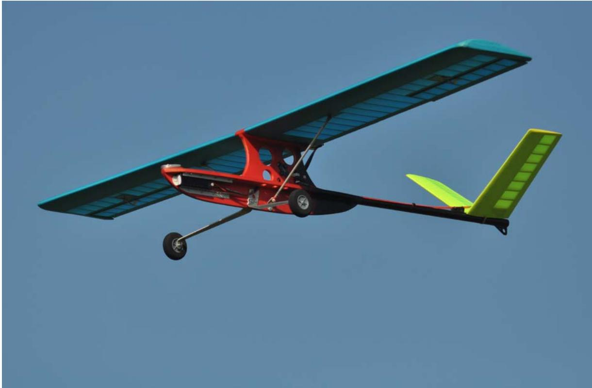
Minimallösung. Nicht mehr als das, was man zum Fliegen unbedingt braucht. Und auch nichts weniger. Flügel, Leitwerk, Motor als Druckantrieb, Räder und die alles zusammen haltenden Platten, die den Namen Rumpf nicht unbedingt verdienen.
