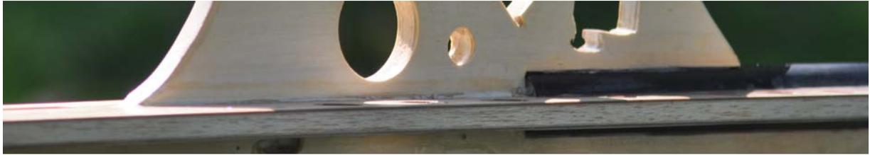
Das Leitwerksrohr im Rumpf ist mittig mit den beiden Platten platziert
