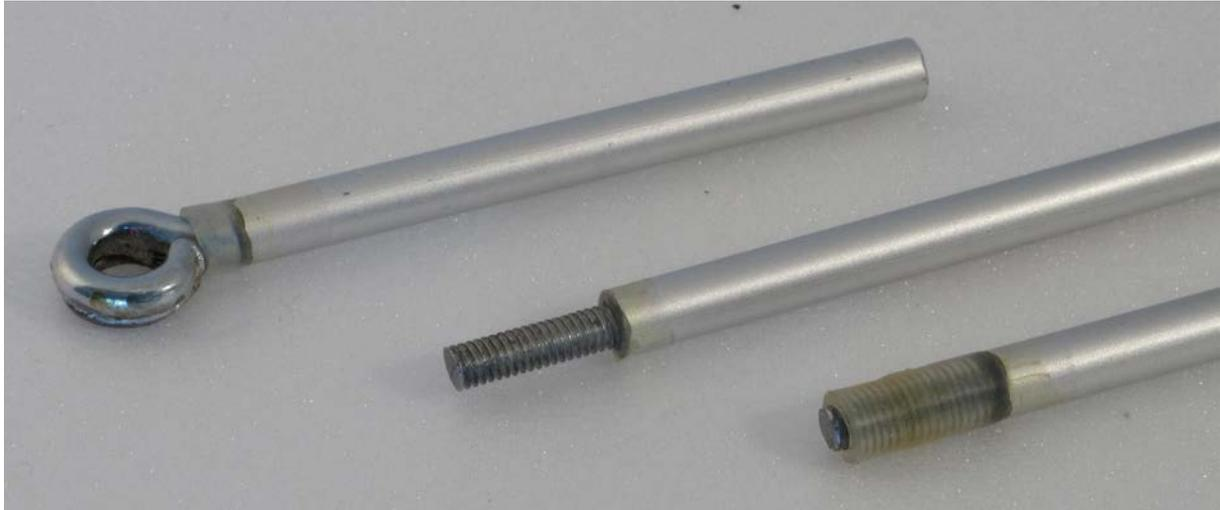
Endstücke der Streben, Alurohr  $\varnothing$  6/4 mm mit M4 Gewinde bzw. M4 Ringschraube. Stückchen Silikonschlauch verhindern, dass das Epoxidharz beim Tempern rausfließt
