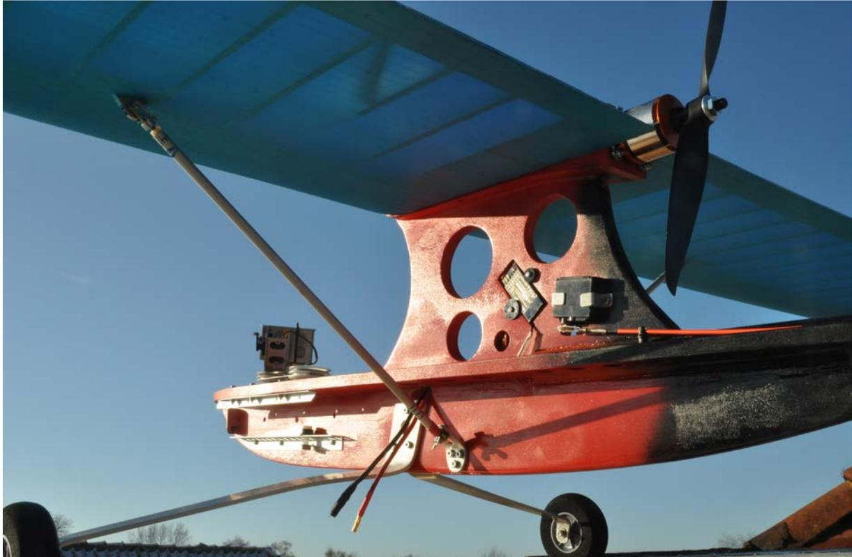
Froschperspektive: Eine Strebe, das Fahrwerk, Empfänger, Servos, Kabel zum Akku (dieser hier nicht installiert, er wird zwischen zwei Aluschienen geschoben; wird anstatt eines 5s ein 4s Lipo verwendet, kann der dünnere Akku mit einem Balsabrettchen „aufgedickt“ werden. So braucht man nicht die Schienen zu versetzen
