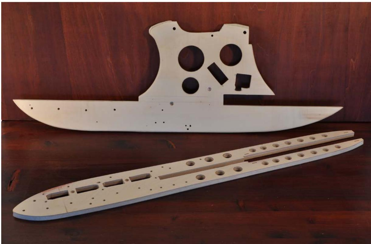
Die beiden Rumpfplatten vor dem Zusammenkleben. Die waagerechte wird in die horizontale hineingeschoben. Oben in der senkrechten Platte ist ein Einschnitt für den Regler anbringen und die Öffnungen für den Empfänger und die Leitwerksservos festlegen und aussägen
