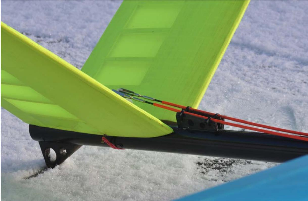
Die Bowdenzüge sind möglichst nah am Leitwerk zu fixieren. Mit einem Gummiring werden die Leitwerkshälften von unten zusammengehalten.
