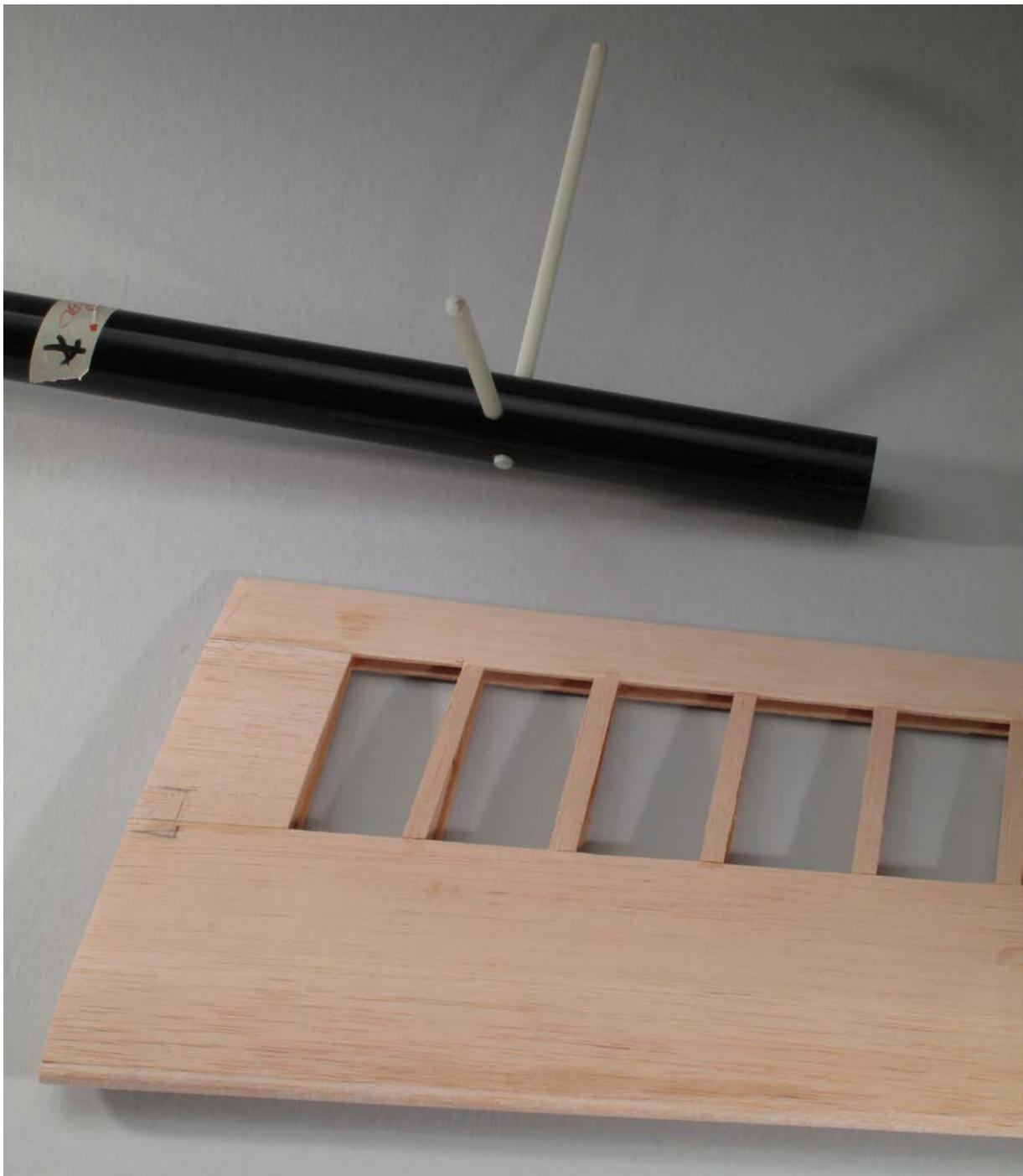
Eine fertige Leitwerkshälfte und die im Leitwerksträgerrohr eingeharzten GFK-Rundstifte. Da diese mit 6 mm Durchmesser überdimensioniert sind, wurden sie an der Stelle, wo sie sich im Rohr kreuzen, mit einer Kerbe versehen werden. So konnte deren Versatz verringert werden, er beträgt nicht 6 mm, sondern etwa 3 mm
