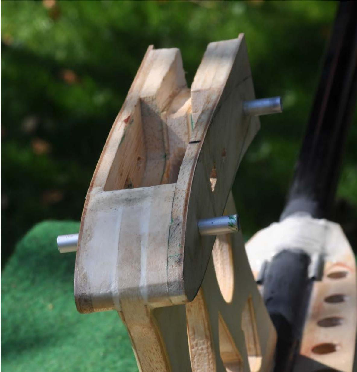
Der ausgefräste Raum für den Regler. Nach hinten werden die Motorkabel verlegt, nach unten führt ein Kanal zum Empfänger, vorn im Reglerraum ist der Kanal für die Akkuzuleitung
