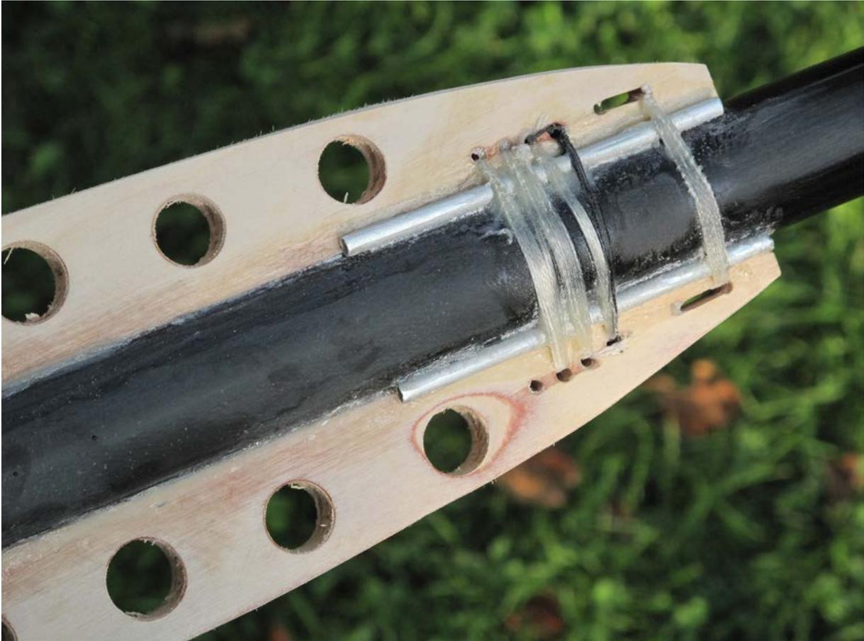
Von oben gesehen. Das Leitwerksträgerrohr wird mit eingedicktem Harz zwischen die Platten eingebaut und eine zusätzliche Umwicklung mit Glasrovings, die sowohl durch die waagerechte als auch durch die senkrechte Rumpfplatte hindurch geht, sorgt für zusätzliche Festigkeit in diesem beanspruchten Bereich.
