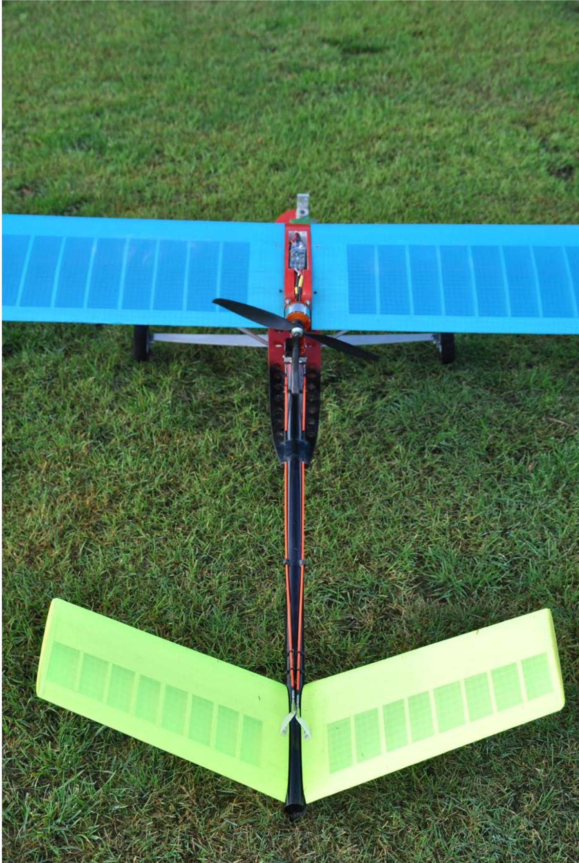
Große Ltw.-Fläche und trotzdem in Pendelausführung. Es funktioniert. Die Bowdenzüge müssen so fixiert werden, dass die Außenhüllen bei Belastung nicht nachgeben. Die ganze Anlenkung muss möglichst spielfrei sein
