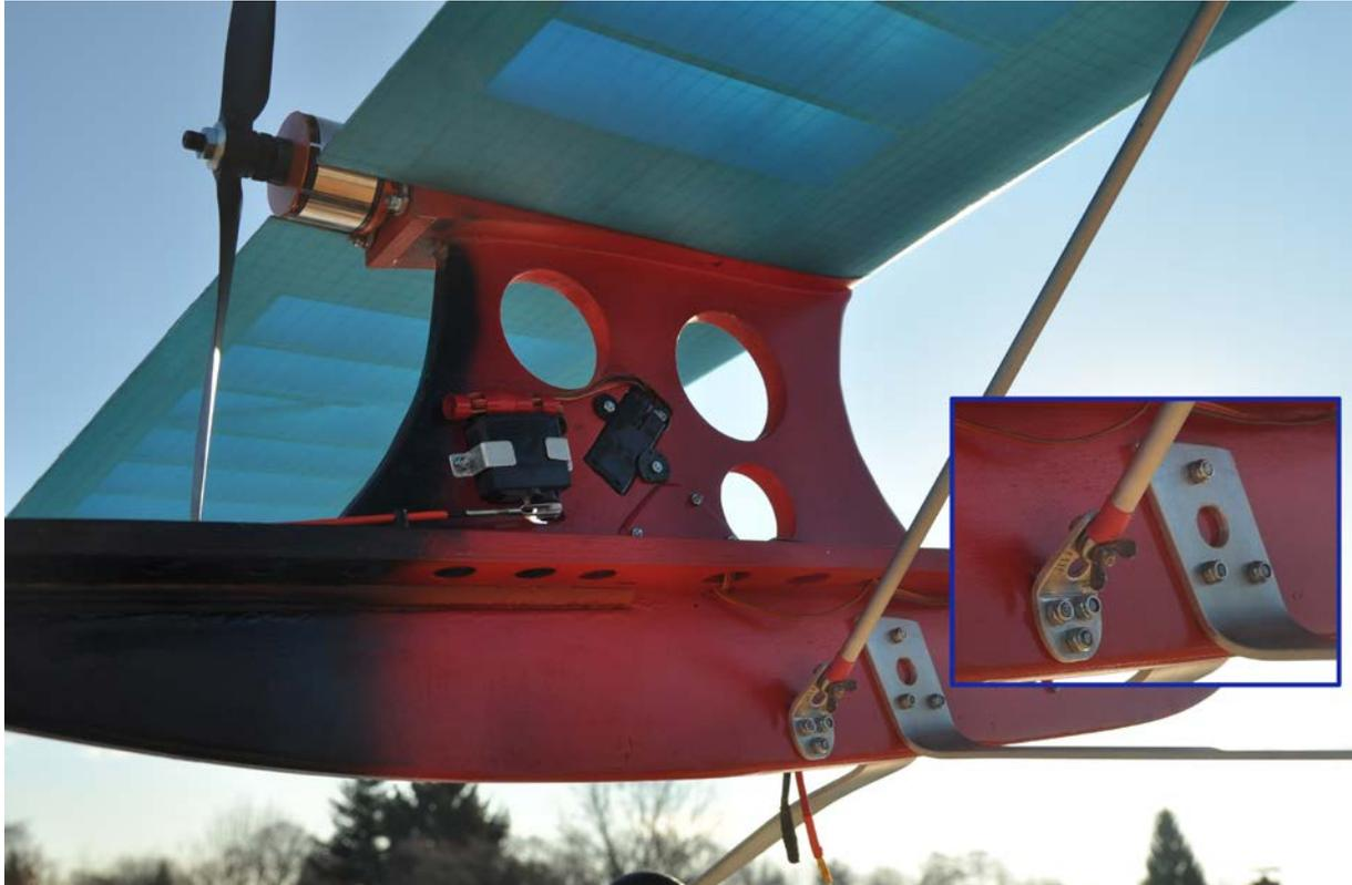
Strebenverankerung am Rumpf. Eine M4 Schraube hält die Ringschraube der Strebe an der Halterung am Rumpf; von unten wird eine Flügelmutter auf die Schraube aufgedreht
