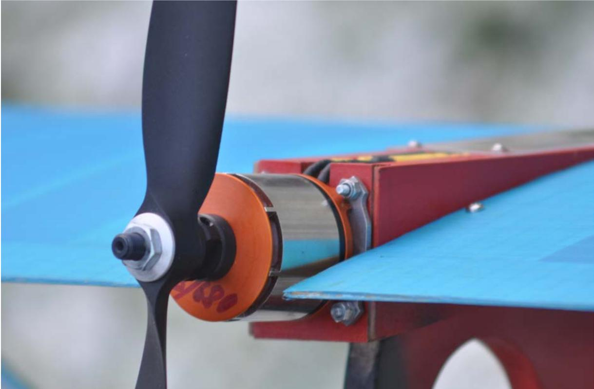
Der Propeller in Druckanordnung ist ziemlich laut. Das ist physikalisch bedingt und wenig beeinflussbar. Dafür stört die Luftschraube nicht bei Foto- und Videoaufnahmen
