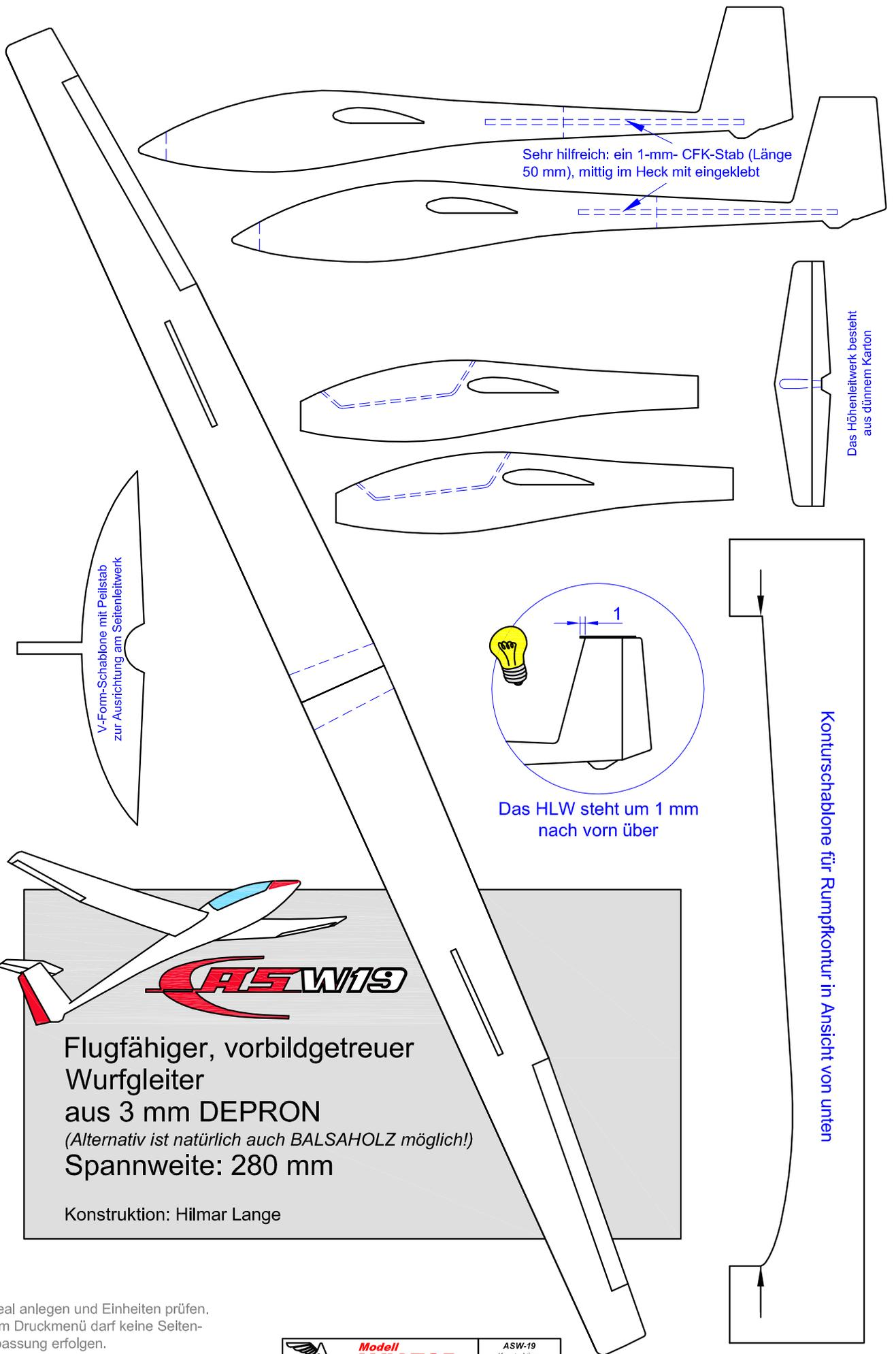
Sehr hilfreich: ein 1-mm- CFK-Stab (Länge 50 mm), mittig im Heck mit eingeklebt
