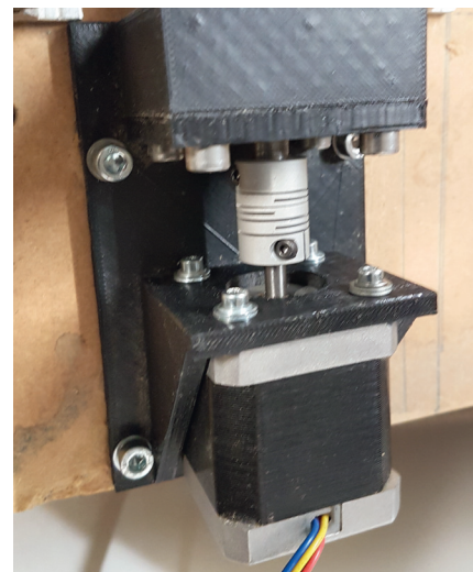
Lagerbock der X-Achse mit integriertem Festlager
