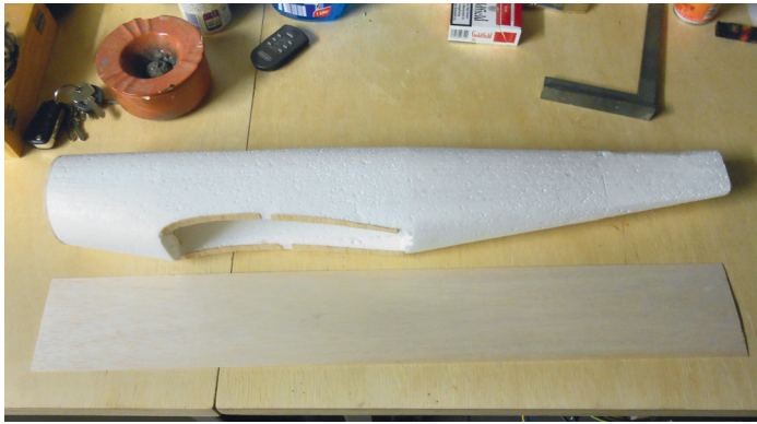
Wie gut CNC-geschnittene Rumpfe sein können, wird hier an der Aircobra ersichtlich, die bereit ist, mit Balsa beplankt zu werden
