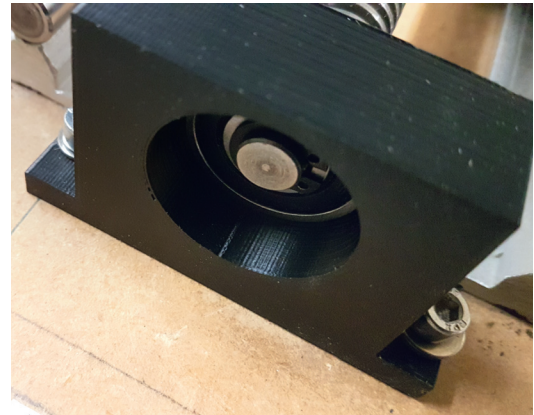
Das Loslager gestattet den Längenausgleich der Spindel
