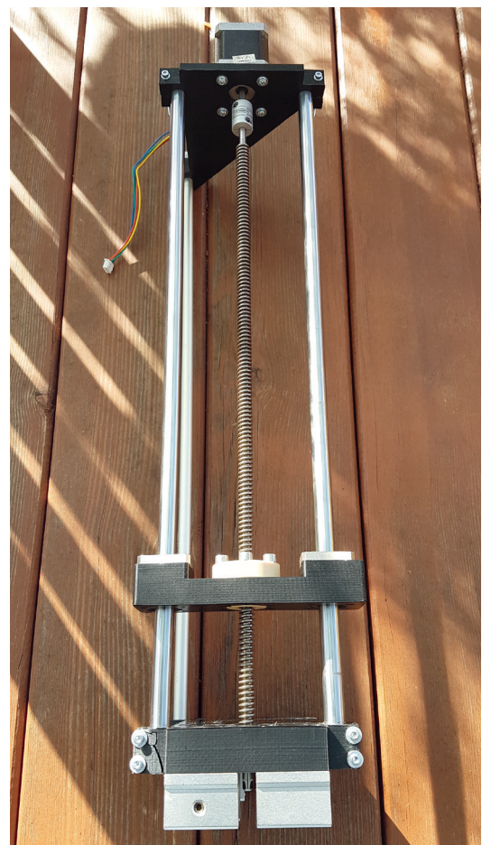
Vollständig montiertes Portal. Es kann jetzt auf dem Tisch der Schneidanlage befestigt werden
