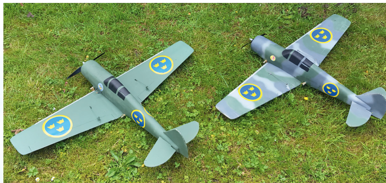
Flügel und Rumpfe der beiden FVVS J-22 bestehen aus CNC-geschnittenem Styro. Die Rumpfe sind mit Paketpapier sowie Parkettlack bespannt, die Flügel mit Balsa beplankt
