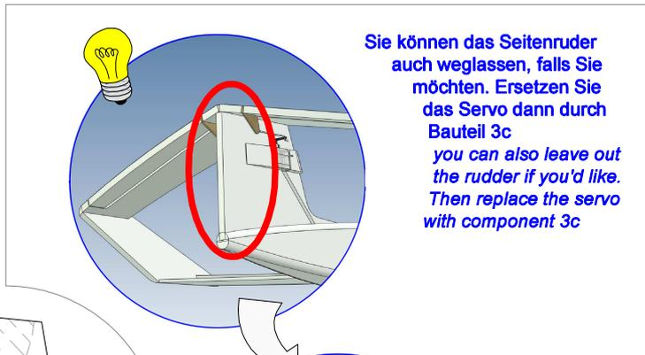
Sie können das Seitenruder auch weglassen, falls Sie möchten. Ersetzen Sie das Servo dann durch Bauteil 3c
