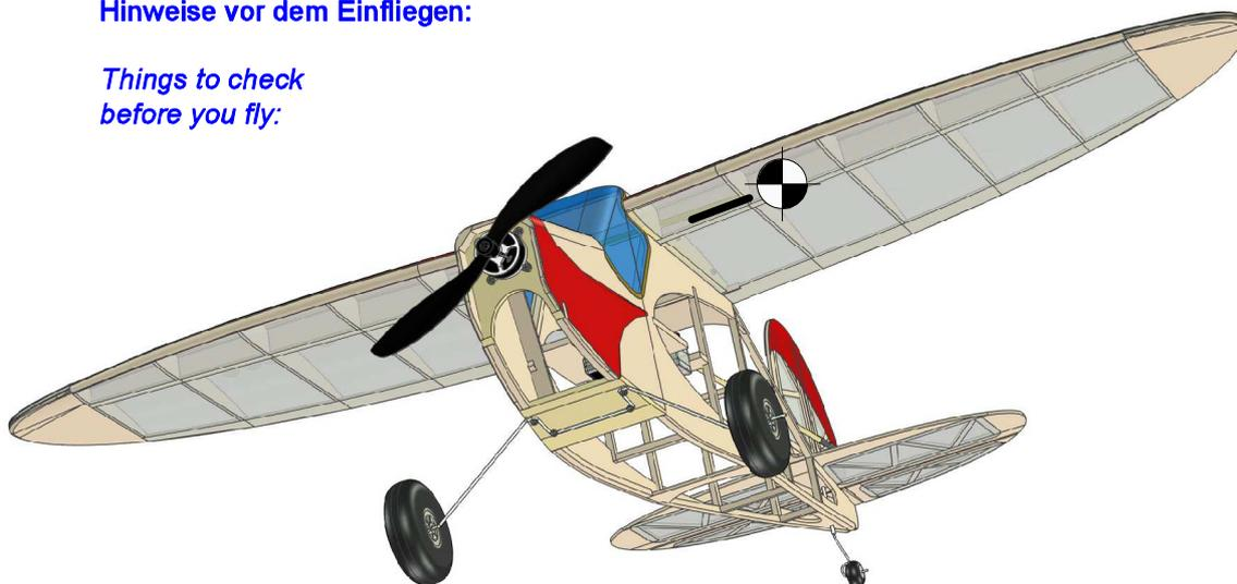
Justieren Sie den Schwerpunkt auf 1,5 mm vor der Holm-Vorderkante durch passende Positionierung des Akkus. Bei Verwendung der vorgeschlagenen Komponenten liegt der Akku auf dem Fahrwerksspannt, bei stärkerem (schwereren) Motor hängt er unter dem Servobrett.
