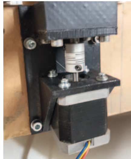
Lagerbock der X-Achse mit integriertem Festlager
