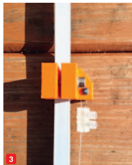
Zahlreiche Elemente der Schneidanlage sind mit einem 3D-Drucker erstellt worden. Die erforderlichen STL-Dateien sind Teil der Download-Dokumentation (1). Exakte Schrittmotoren ermöglichen das Führen des Schneidbogens (2). Zum Schneiden kommt ein Widerstandsdraht zum Einsatz. Auch hier stammt die Halterung aus einem 3D-Druck-Teil (3)
