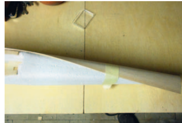
Festigkeit erhalten Styroporteile durch Beplanken mit Holz oder beispielsweise GFK-Auflage. Auf jeden Fall werden somit klasse Modelle möglich
