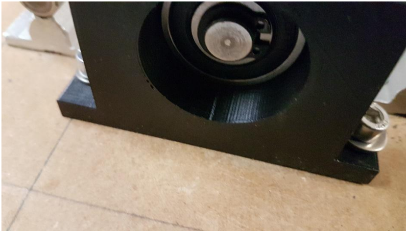
Abbildung 34: Spindel im Loslagerbock
