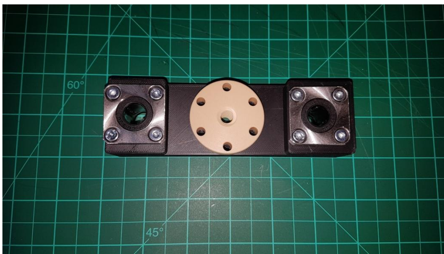
Abbildung 27: Zusammengebauter Y-Wagen, die Schrauben für die zentrale IGUS Drylin Mutter sind auf dem Bild noch nicht eingeschraubt
