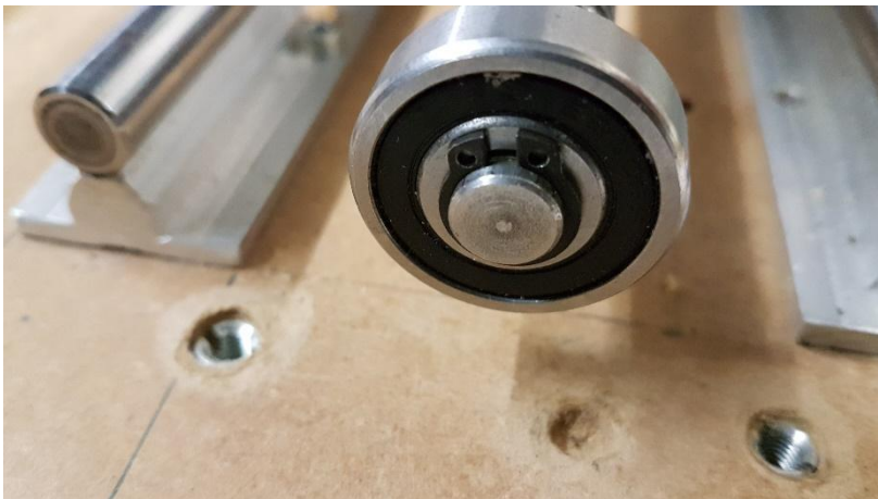
Abbildung 33: Montiertes Loslager
