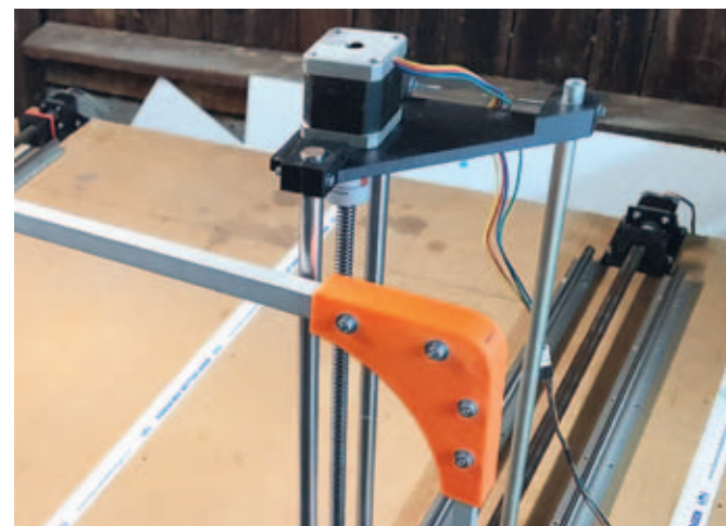
Die CNC-Schneidemaschine ist so aufgebaut, dass sie den Bogen auf zwei Seiten in X- und Y-Richtung führen kann
