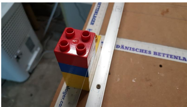
Abbildung 72: Ermittlung der Nullstellung in X-Richtung mit Lego DUPLO Steinen
