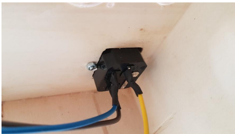
Abbildung 60: Verkabelter und montierter Kaltgerätestecker mit Sicherungseinsatz
