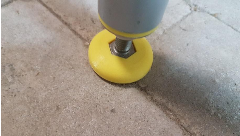
Abbildung 25: Montierte Feinjustierung der Tischbeine
