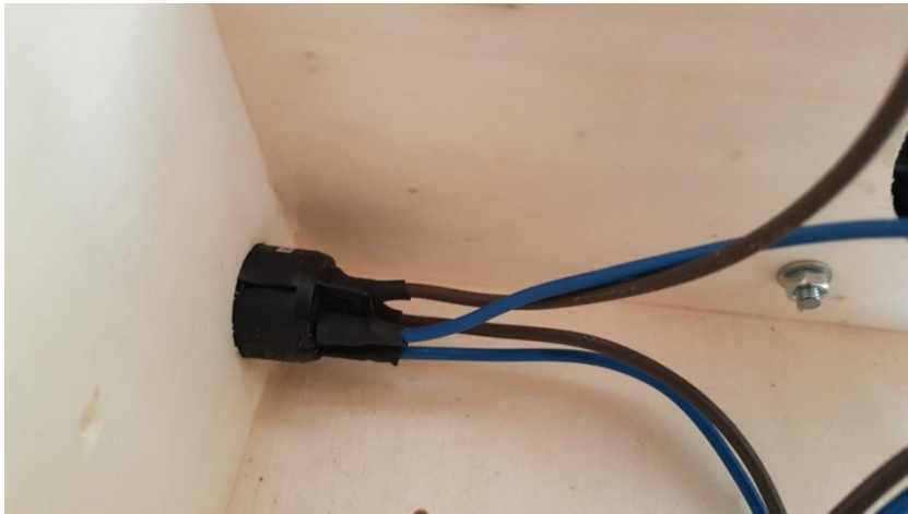
Abbildung 61: Verkabelter und montierter beleuchteter Schalter
