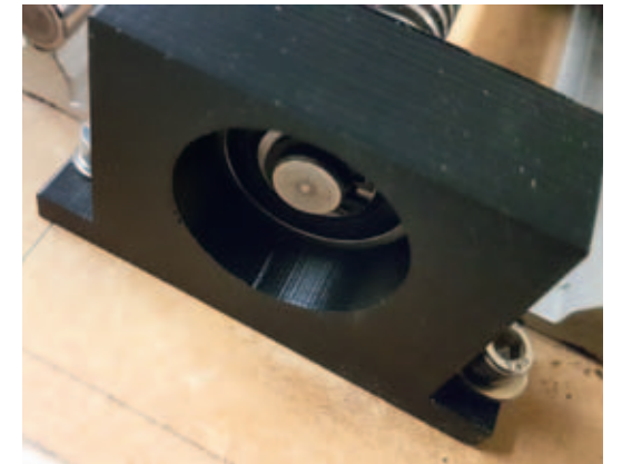
Das Loslager gestattet den Längenausgleich der Spindel
