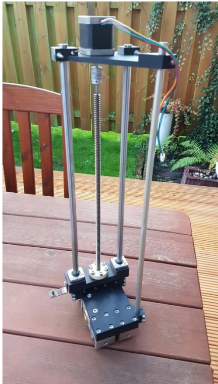
Abbildung 30: Ein fertiges Portal, hier noch mit dem Mitnehmer meiner ersten Maschinenversion
