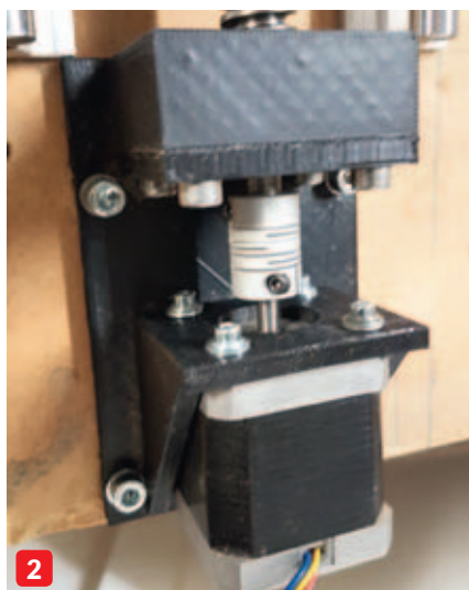
Zahlreiche Elemente der Schneidanlage sind mit einem 3D-Drucker erstellt worden. Die erforderlichen STL-Dateien sind Teil der Download-Dokumentation (1). Exakte Schrittmotoren ermöglichen das Führen des Schneidbogens (2). Zum Schneiden kommt ein Widerstandsdraht zum Einsatz. Auch hier stammt die Halterung aus einem 3D-Druck-Teil (3)
