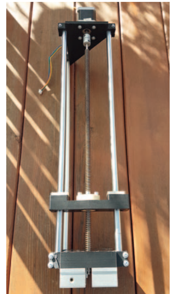
Vollständig montiertes Portal. Es kann jetzt auf dem Tisch der Schneidanlage befestigt werden
