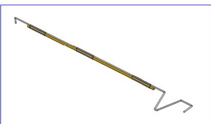
Die Querruder-Anlenkung kommt ohne Führung aus und wird mit einem Holzrundstab versteift. Ein Tropfen UHU por hindert den Draht daran, aus dem Horn zu rutschen.
