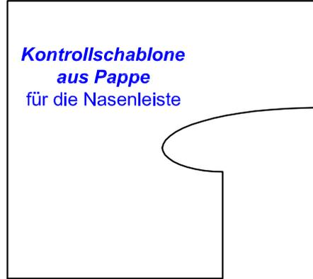
Klebefläche für 2 x 4 mm Depron-Auffütterungsleiste
