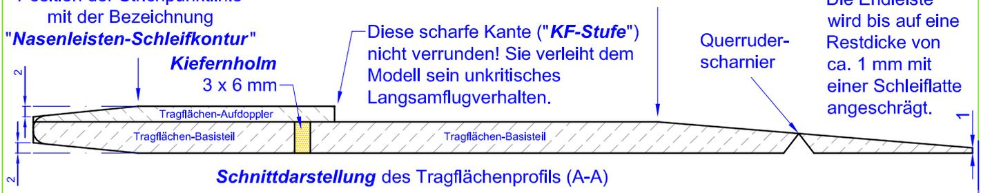
Diese scharfe Kante ("**KF-Stufe**") nicht verrunden! Sie verleiht dem Modell sein unkritisches Langsamflugverhalten.
