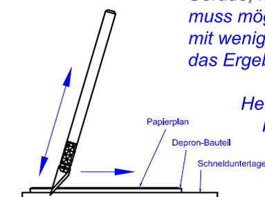
Heften Sie dazu den Bauplan-Ausdruck mit etwas Klebestift oder Sprühkleber auf dem Depron auf, und verwenden Sie ebenfalls Depron als Schneidunterlage.
