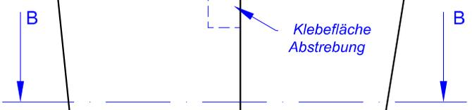
Schnitt B-B durch das Leitwerk
